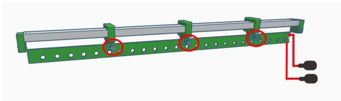
2. Inserisci gli iangolari nei tubi verticali del telaio, se necessario aiutandoti con un martelletto. Non usare troppa forza, basta solo che gli inserti di plastica arrivino al bordo, quindi blocca la centralina al telaio con i suoi dadi e viti e inserisci i connettori faston negli appositi spinotti.
