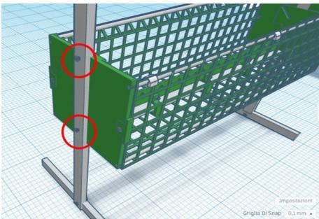
Avvita la barra AT ai 3 supporti e inserisci il tutto nel telaio trasversale, quindi inserisci gli inserti angolari.
